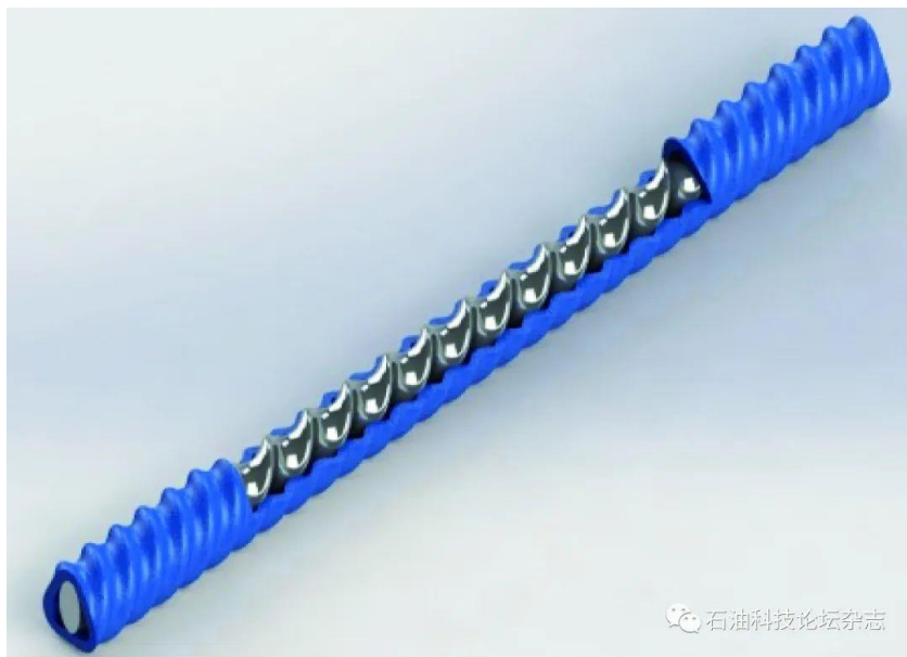
图2 等壁厚螺杆泵三维结构
